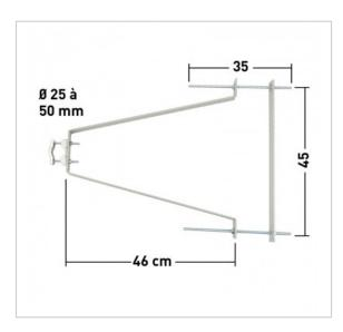
• Pour mâts ø 25 à 50• Entraxe 2 perçages 45 cm• Acier de 45 x 5 mm• Fixation renforcée du mât par mâchoires et étriers crantés• Oblongs pour faciliter la fixation murale• La paire
