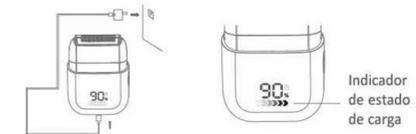
1. Para cargar el producto, inserte el extremo del cable TIPO-C en la ranura de carga del producto e inserte el otro extremo del cable de carga en el cabezal del cargador.
