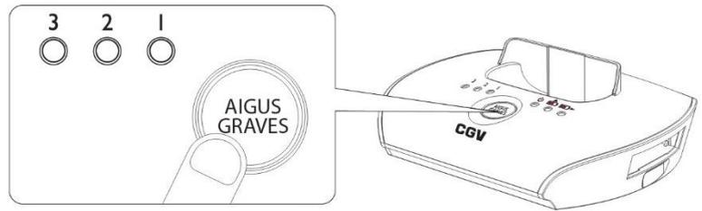
1. Sur la station d'accueil, appuyez sur **[AIGUS/GRAVES]** modifie le réglage de tonalité (cf. §4.2 n°3). Répétez l'appui pour sélectionner le réglage souhaité.
