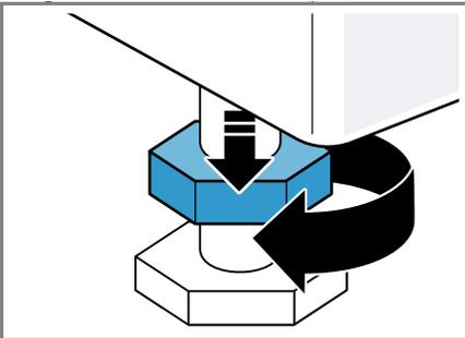
2. Pour aligner l'appareil, tournez les pieds de l'appareil. Vérifiez l'horizontalité avec un niveau à bulle.
