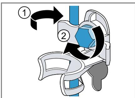
5. Insérez le tuyau dans le support.
