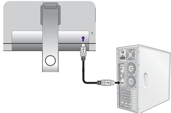
Conecte los dispositivos USB a través de los otros puertos USB (descendentes) del monitor. Estos puertos USB descendentes transmiten los datos entre los dispositivos USB conectados y el puerto ascendente.
