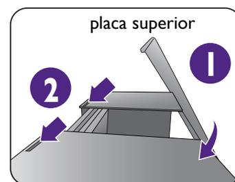
7. Si pretende calibrar el color de la pantalla con un colorímetro, deslice y abra la tapa de la placa superior de modo que se pueda instalar el colorímetro.
