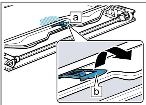
8. Soulevez la vitre intermédiaire par le bas <sup>①</sup> et retirez-la dans le sens de la flèche <sup>②</sup>.
