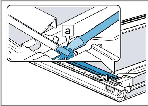
5. Soulever le réflecteur **b** à l'aide du tournevis<sup>①</sup>, jusqu'à ce qu'il se détache, puis le soulever et l'extraire<sup>②</sup>.
