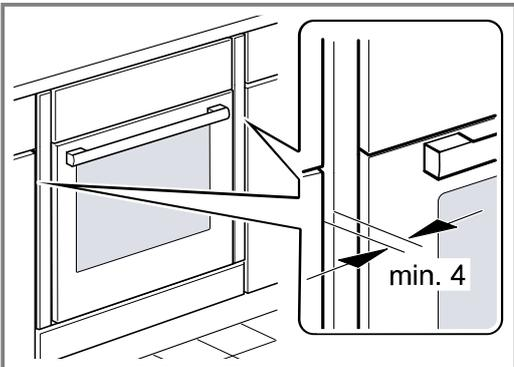
Une fente d'aération de 4 mm est nécessaire entre l'appareil et la façade des meubles voisins.
