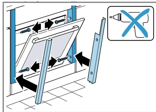
**Remarque :** L'écart entre le plan de travail et l'appareil ne doit pas être obturé par des baguettes supplémentaires.
